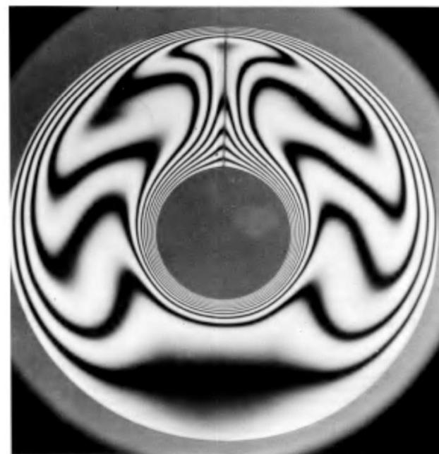
конвекция в зазоре между двумя цилиндрами (внутренний цилиндр горячий)
