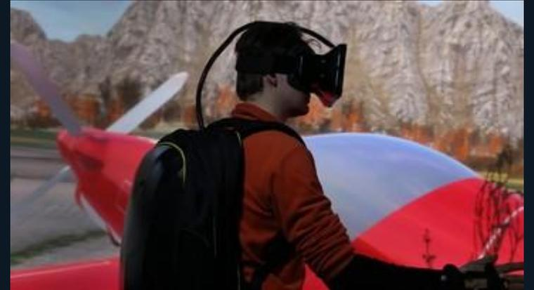
Компактная система виртуальной реальности позволила отказаться от необходимости создания полноразмерных посадочных макетов и масштабных моделей, что открыло новое направление применения КСВР — виртуальное прототипирование
